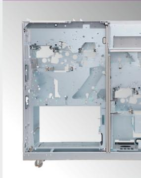
Passgenaue Platinen mit zusätzlicher Oberflächen-Veredelung in der Größe 1800 x 1300 mm. Inklusive Montage von Teleskopschienen für motorgetriebenen Papierauszug sowie über 30 Stück gefrästen Aluminiumstrangpressprofilen. Die geforderte Genauigkeit der Ebenheit sowie des Abstands der Platinen zueinander beträgt +/- 0,05 mm.
