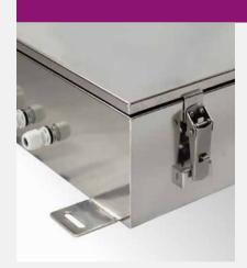
Die Treiberbox lässt sich durch ihre robuste und stabile Bauform schnell montieren und in das Beleuchtungssystem integrieren. Das Gehäuse besteht aus Edelstahlblech V4A, nach DIN 17440, WNr. 1.4571 (AISI 316Ti) mit hoher mechanischer Festigkeit und Korrosionsbeständigkeit (austenitischem, säurebeständigem 17/12/2 Cr-Ni-Mo-Ti-Stahl).
